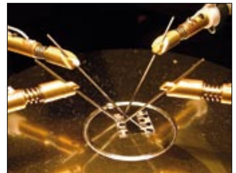
Glerflaga sem á hafa verið prentaðar rafrásir og vökrarásir. Flögur af þessu tagi má t.d. nota til greiningar á mjög litlum vökvásnum. Ljósmynd: Jón Skírniir Ágústsson.
