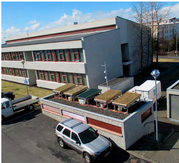
Mynd 2 Yfirlitsmynd af tilraunaþökum á lóð Háskóla Íslands. Frá hægr: (1) Úthagi + torf; (2) Úthagi + jarðvegur; (3) Bárújárn; (4) Gras + torf; (2) Gras + jarðvegur;
