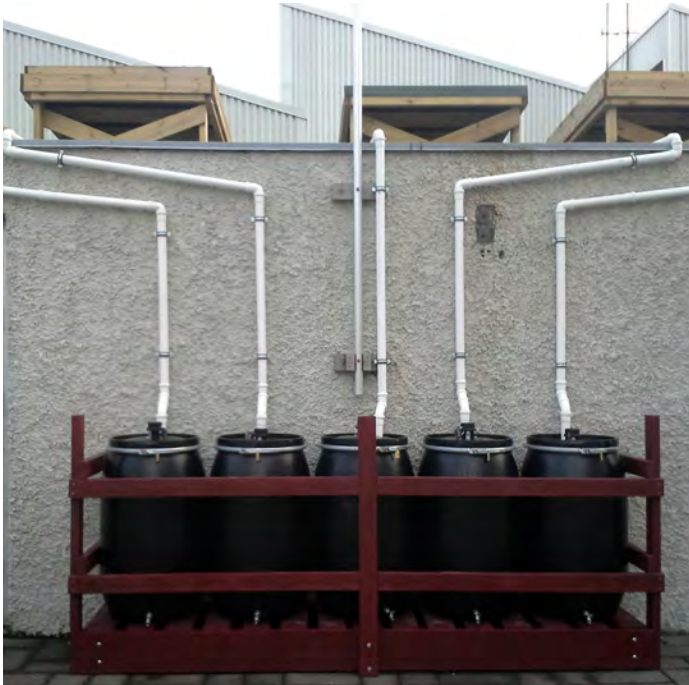
Mynd 3. Afrennslisöfnun af tilraunaþökum með 220L tunnum (t.v.) og 2 m háum 250x6 mm PE100 plaströrum (t.h.).
