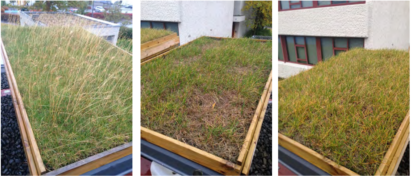
Mynd 6: Gróðurþekja 4. október 2015: a) Úthagi með jarðvegsblöndu í undirlagi (þak 2), b) gras með torfi í undirlagi (þak 4) og c) gras með jarðvegsblöndu í undirlagi (þak 5).
