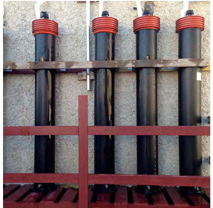
Mynd 3. Afrennslisöfnun af tilraunaþökum með 220L tunnum (t.v.) og 2 m háum 250x6 mm PE100 plaströrum (t.h.).
