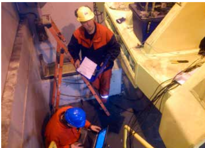
Hafsteinn Óskarsson (Verkís) og Indriði Ríkhartðsson (HR) við strain gauge mælingar.
