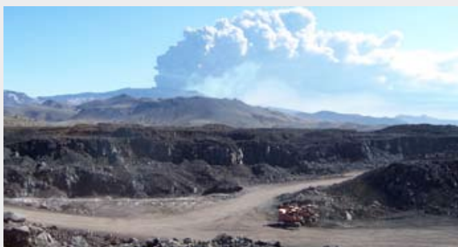
Grjótnámur í Kattarhrygg í Seljalandsheiði. Efnismagnið sem þarf í svo öflug mannvirki er alls um 1,3 milljón tonn af grjóti en heildarmagnið í verkinu er um 2 milljónir tonna. (Mynd: Bjarni Guðmundsson).
